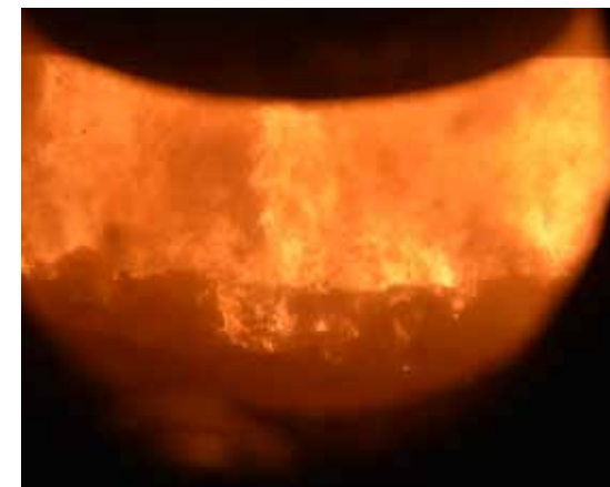
Le four de l'usine Alcea - incinération des ordures ménagères
