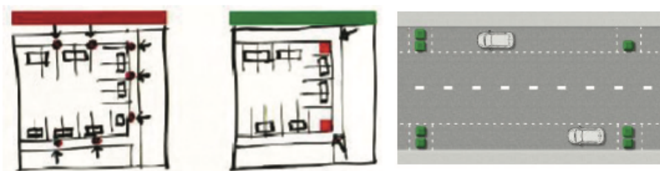
Schémas de principes de positionnement des équipements de collecte dans un quartier. «Guide de la qualité urbaine et d'aménagement durable». C.U Bordeaux, A'Urba, 2008. «Une voirie pour tous. Encombrement des trottoirs». Certu. Fiche 3.2. Mars 2010
